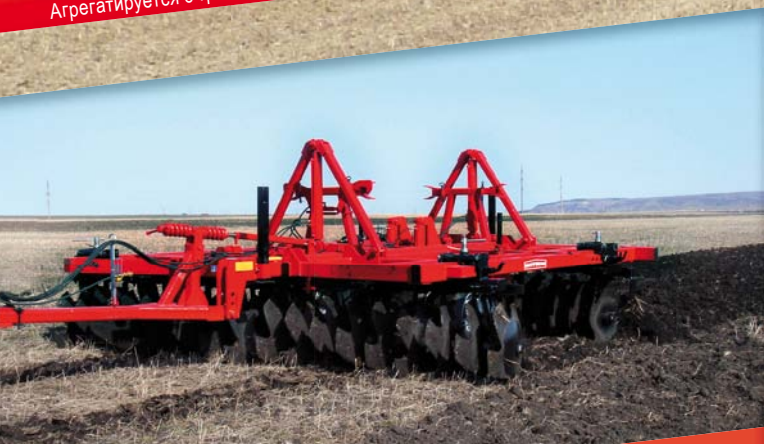
ПРИЦЕПНАЯ ДИСКОВАЯ БОРНА APVRS ФЛЕО-ФЛЕО Ширина захвата 4 - 9 м, диски уникальной лепестковой формы Ø 810 мм Агрегируется с тракторами от 240 л.с.
